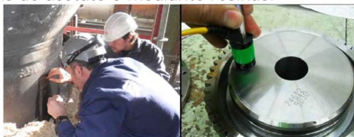
Como ensayos complementarios al estudio microestructural se realizan medidas de durezas in situ. Dichas medidas pueden mostrar una tendencia de los valores y así conocer cómo las propiedades mecánicas de los materiales varían con el tiempo y las condiciones de operación.
