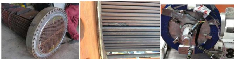
El grupo TecnaTom ha desarrollado equipos, sondas, software procedimientos de trabajo (cumpliendo los requisitos del código ASME) para realizar inspecciones en componentes de con tubos ferromagnéticos. Esta técnica de inspección (RFEC) está siendo una técnica ya implantada con grandes y efectivos resultados en Refinerías, Termosolares, e Industria en general por el gran número de componentes con tubos ferromagnéticos.
